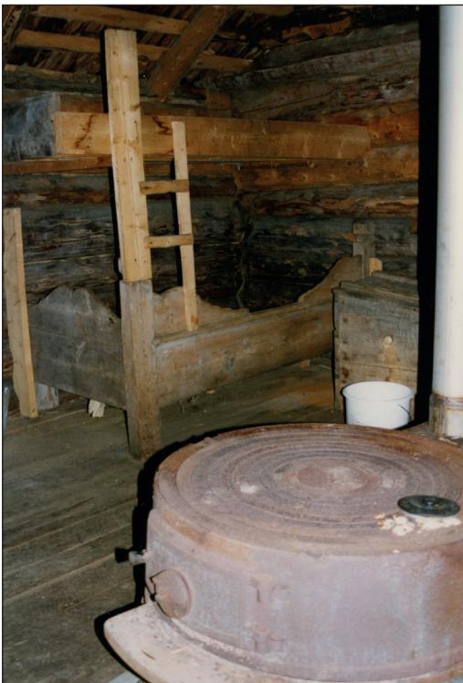
Sengene til stulsfolket. Den underste er nok en eldre utbyttet seng fra Haatveit. I forgrunnen "kasleringen", en ovn som bruktes til alt av koking innendørs. Merk de løse ringene i hele overdelen som gjorde det mulig å tilpasse alle størrelser kjeler rett i varmen under. "Kasle" er navnet på en stor kjele (f.eks. primkjelle) fra gammelt av. Derav navnet kaslering.
